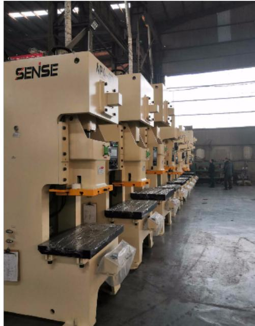
冲床在单侧裁切的全过程中，原料、模座和型腔都是造成个纵向力水准作用力，这一纵向力会造成原料晃动、齿面间娘扩大、裁切精神分析法堡降低等负面影响咽此在设计方案冲压模时滁了结构类型要到取合理对策来避免纵向力产生的负面影响比如模座、型腔反侧压构造或设备，在选择齿面空隙时，针对单侧裁切齿面的空隙，一般取一切正常空隙的30%-50%冲床，就是一台冲压式压力机。在国民生产中，冲压工艺由于比传统机械加工来说有节约材料和能源，效率高，对操作者技术要求不高及通过各种模具应用可以做出机械加工所无法达到的产品这些优点，因而它的用途越来越普遍。在零件加工和组装生产线上，工件的搬运、转运、定位、夹紧进给、装卸、装配、清洗、检测等。佛山分体式冲床设备
