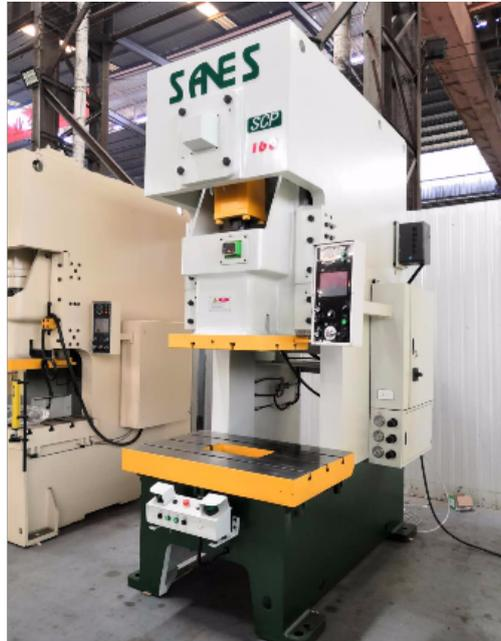
冲床根据该滑块调节设备可以临时性的调整磨具的空隙，以便捷磨具的维护保养精密冲床实际上应用时，导轨滑块调节装置的丝杆相互配合调节螺丝帽促进摇杆往上或往下晃动，在摇杆往上或往下晃动时，球座与丝杆下web端圆球部相互配合便于丝杆随摇杆小视角的晃动，避免卡住’并根据圆球部的卡掣部与蜗轮的插槽的相互配合，促使丝杆在小视角的晃动全过程中，仍能与精密冲床导轨滑块调节装置蜗轮同步旋转；摇杆往上或句下晃动的全过程中推动偏心轮在曲轴的偏心轮孔内旋转，进而根据偏心轮的轴力孔推动连接消冉冉升起或降低，以保持调整高速冲床导轨滑块高宽比的作用！
